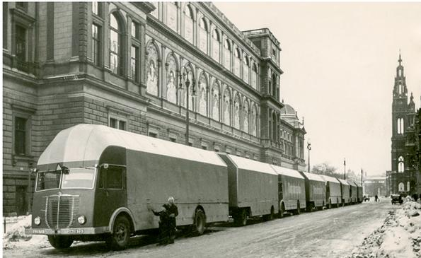
Abb. 1.21: Die fahrbare Ausstellung Der Vierjahresplan. Die Seitenwände der Lastwagen waren aufklappbar und wurden als Dach für die Ausstellungs-„Halle“ genutzt.
