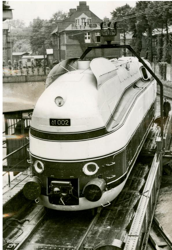
Abb. 1.23: Am Bahnhof Berlin-Grunewald traf am 13. Juni 1939 die von der Lokomotivefabrik Henschel und Sohn in Kassel erbaute damals schnellste Lokomotive der Welt ein. Statt des üblichen Zweizylinder-Triebwerkes hatte die neue Schnelllokomotive ein Dreizylinder-Triebwerk und erreichte eine Höchstgeschwindigkeit von 185 km/h.
